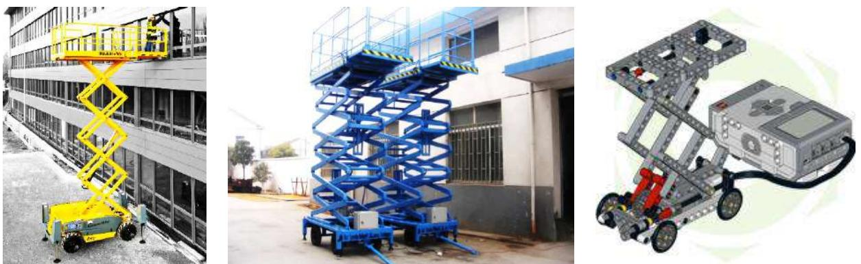
**Ножничный подъёмник** – это подъёмник с системой рычагов и гидравлических цилиндров, на которую опирается металлическая платформа, способная перемещаться в вертикальной плоскости.
