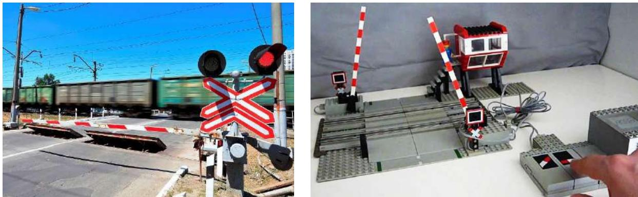
**Железнодорожный переезд** — место пересечения в одном уровне железных дорог с автомобильными дорогами (трамвайными путями, троллейбусными линиями), либо велосипедной или пешеходной дорожками, и в зависимости от условий работы оборудуются одним из следующих устройств: автоматической светофорной сигнализацией; автоматической светофорной сигнализацией с автоматическими шлагбаумами; автоматической оповестительной сигнализацией с неавтоматическими шлагбаумами.
