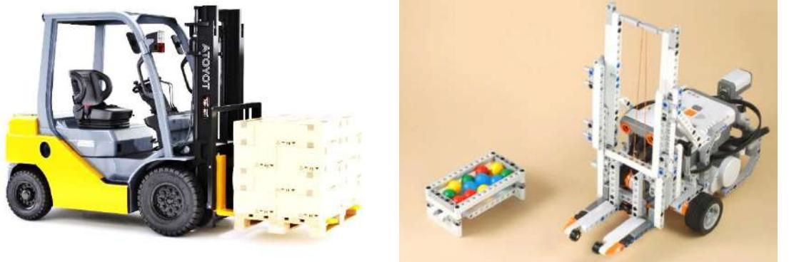
**Вилочный погрузчик** — вид специального складского напольного транспорта, предназначенного для поднятия, перемещения, разгрузки, погрузки, складирования (штабелирования) паллетов, поддонов и других грузов при помощи вил или других рабочих приспособлений (навесного оборудования).
