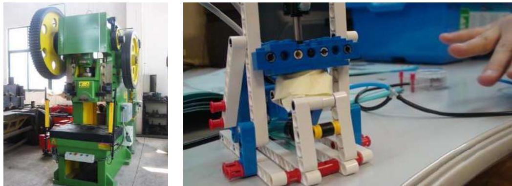
**Пресс** — механизм для производства давления с целью уплотнения вещества, выжимания жидкостей, изменения формы. На производстве прессы чаще всего используются, как устройство, позволяющее деформировать материалы с помощью механического воздействия для процесса штамповки. Штамповочные работы, штамповка, штампованием — пластиическая деформация материала с изменением формы и размеров тела. Чаще всего штамповке подвергаются металлы или пластмассы. По конструкции прессы бывают: вал-
